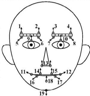
根據Facial Action Coding System (FACS)在臉皮後方設置欲移動的區域(控制點)
